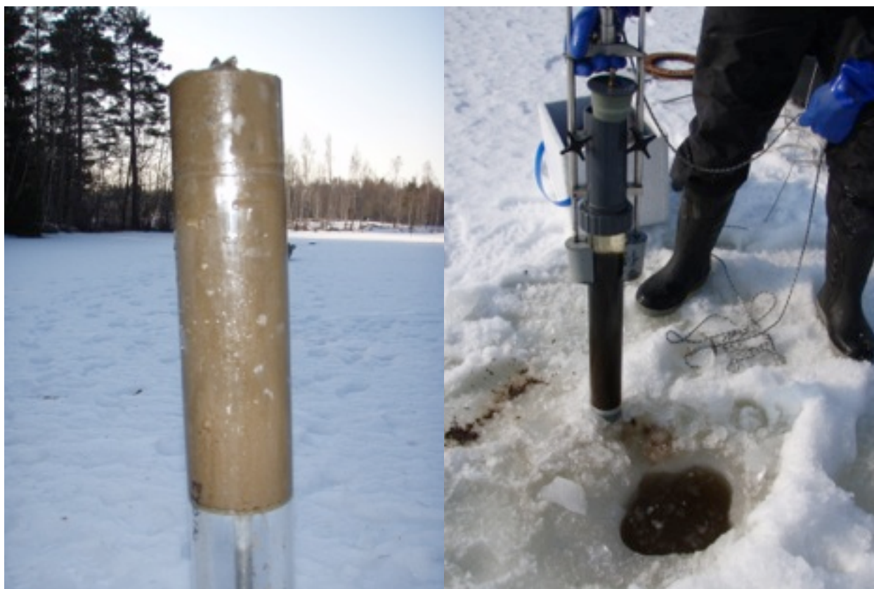
Sedimentpropp från damm vid Isgårda och sedimentprovtagning med Willnerhämtare
