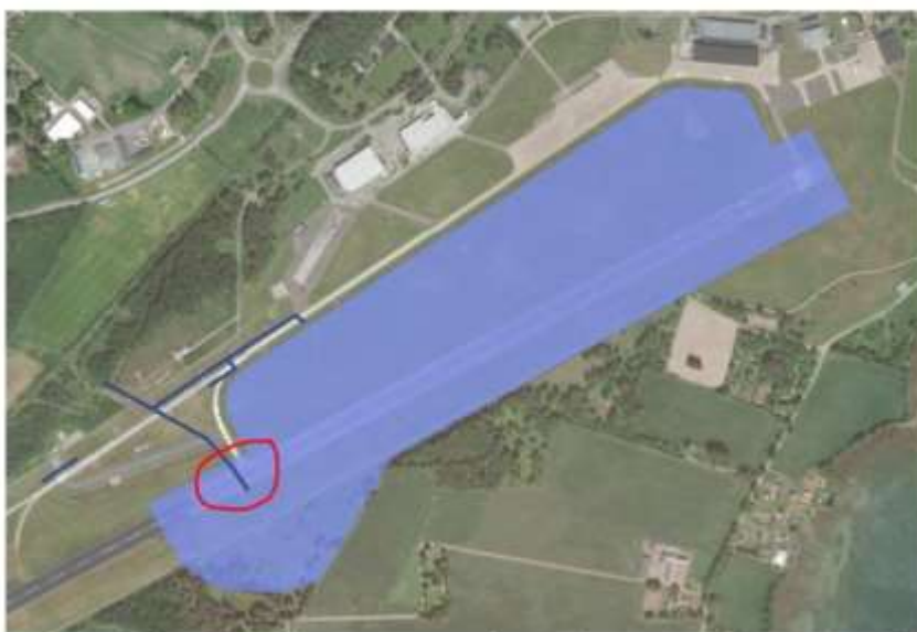
Figur 3. Område som kan avledas separat, åtskilt från mer förorenade flöden. Blå streck är ledningar som ska införas. Röd ring visar var det är möjligt att samla flödena av dränvattnet från blått område.
