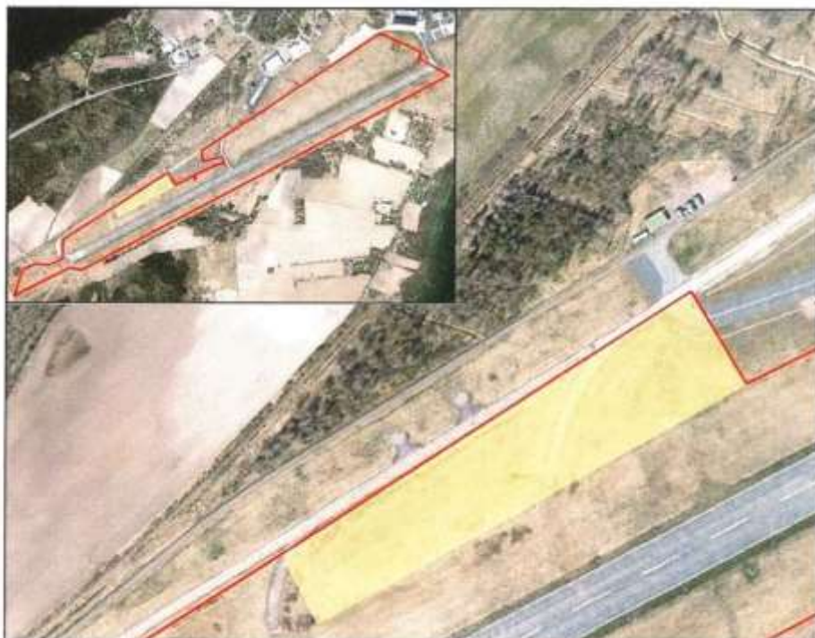
Figur 22. Område söder om brandövningsplatsen, där nya dräneringar med vattengång lägre än 90,2 m inte ska anläggas (ljusgult). Röd linje – gräns för markavvattnat område.
