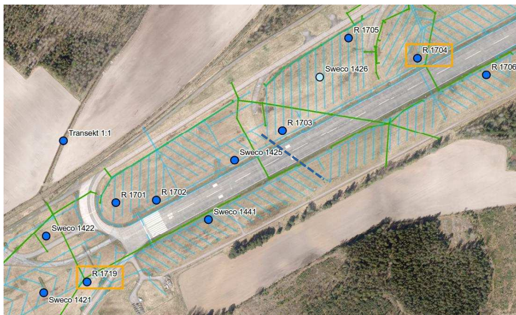
Figur 8. Installerade grundvattenrör i anslutning till sydvästra banändan vid Karlsborg. Kontinuerliga mätningar har utförts i grundvattenrör markerade med orange rektangel. Streckad linje vid R1703 indikerar bedömd grundvattendelare vid rullbanan.
